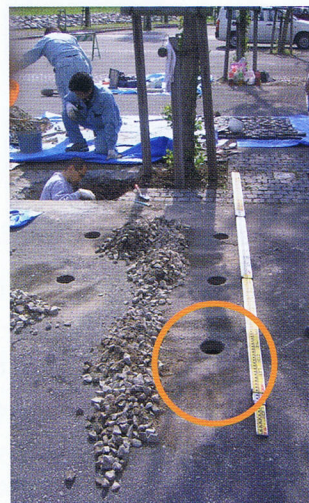
(テストピース用のコア抜き状況)
